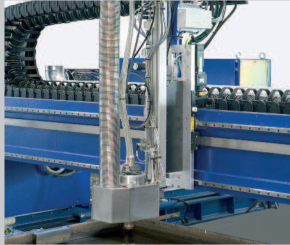
Unterwasser-Plasmaschneidkopf mit integriertem Havarieschutz. Underwater plasma cutting head with integrated collision protection.
