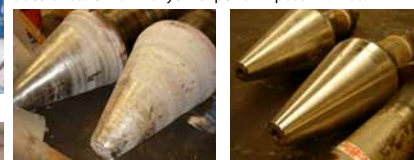
Изношенные и восстановленные роликовые конуса
