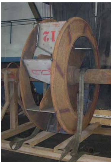
Вентилятор из износостойких пластин с порошковым напылением
