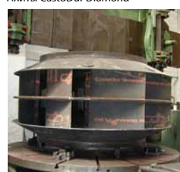
Защита от износа выходного вентилятора
